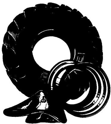
Рис. 102. Покрышка, камера и обод колеса трактора
